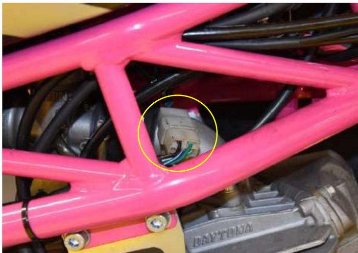
Collegare i connettori del cablaggio QSH in linea con i connettori originali.
