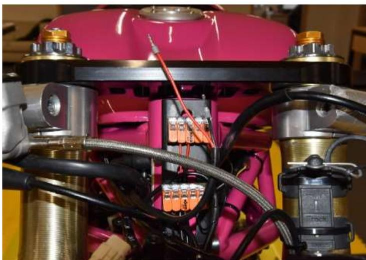
Posizione tipica per la batteria e l'interruttore on/off.
