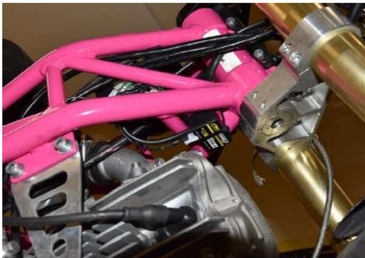
Collegare il filo rosso del cablaggio QSH al terminale positivo della batteria tramite un interruttore on/off.
