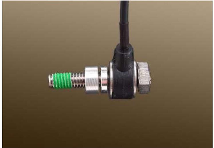
Montare il sensore QSE sotto il bullone della leva del cambio.
