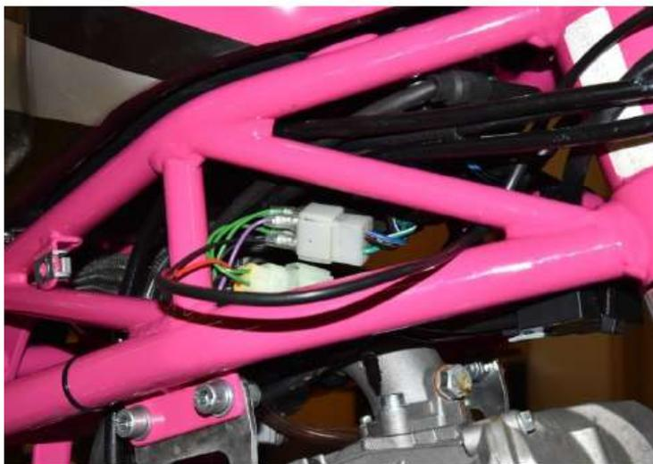
Utilizzare il cavo nero in dotazione (con due occhielli) per mettere in collegamento di massa il terminale negativo della bobina di accensione ed il motore.
