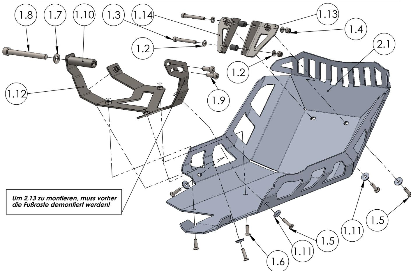
Um 2.13 zu montieren, muss vorher die Fußraste demontiert werden!
